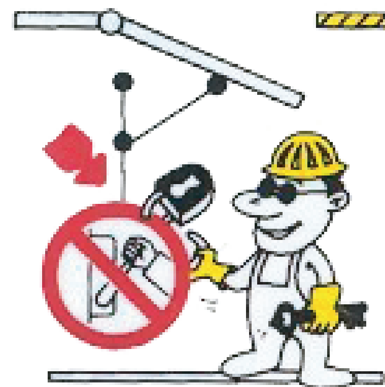
2. Bloqueo y señalización para prevenir cualquier posible realimentación.
