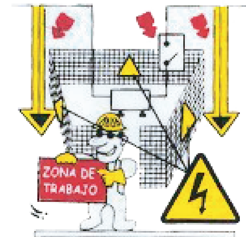
5. Proteger frente a elementos de tensión y señalizar la zona.
