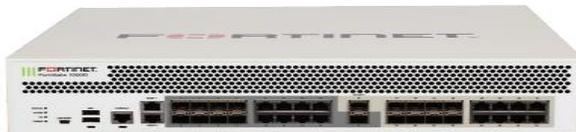
**Uso:** Instalación de los FG-2000E como Firewalls de Segmentación de la red Interna (ISFW).
